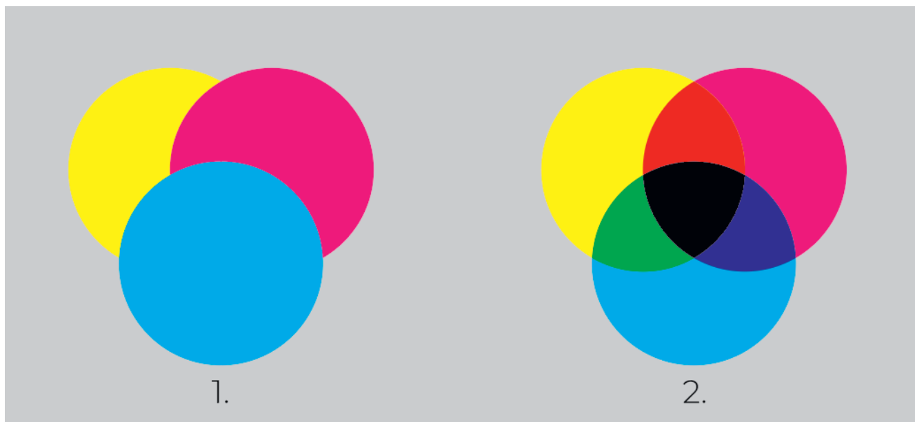
Приказ на елементи каде што: 1. опцијата overprint е исклучена 2. опцијата overprint е вклучена
